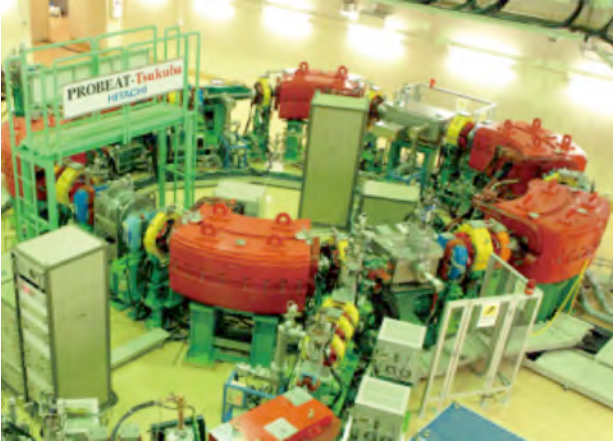
図 13 陽子線治療装置外観（筑波大学）[9]
